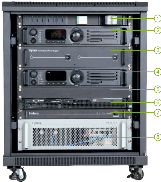
BS de duas repetidoras de 400-470 MHz 600*600*675 mm
